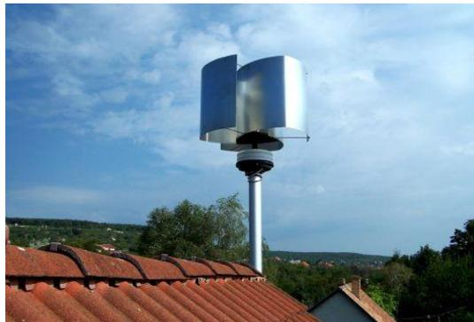
Gambar 2.6 Kincir Angin Sumbu Vertikal<sup>23</sup>
