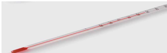
Gambar 2.8 Termometer Air Raksa
