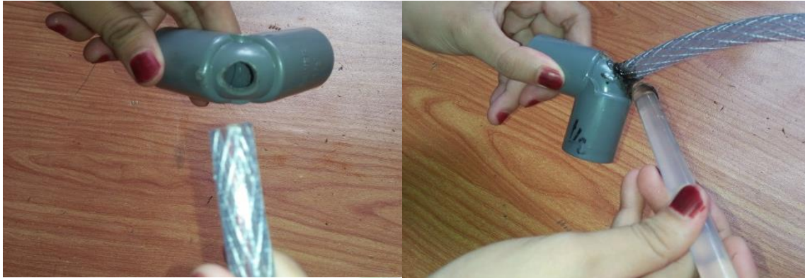
Gambar 4.3 Perakitan saluran udara menggunakan pipa L dan selang
