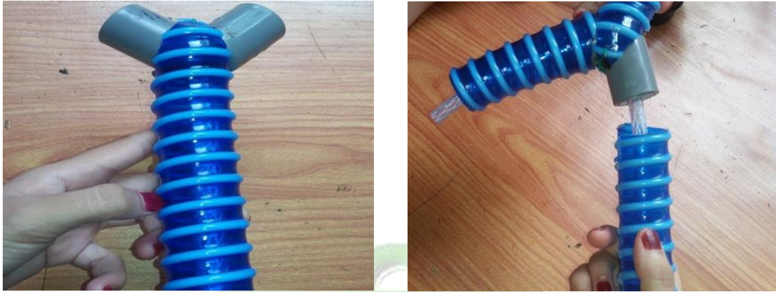
Gambar 4.4 Pemasangan selang dan pipa L
