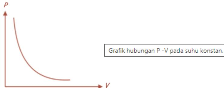
**Gambar 2.1 Grafik hubungan P-V pada suhu konstan (isotermal)**
