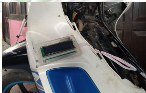
Gambar 3.8 Peletakan LCD 16x2
