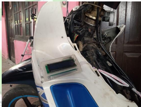
Gambar 4.9 Pemasangan LCD 16x2
