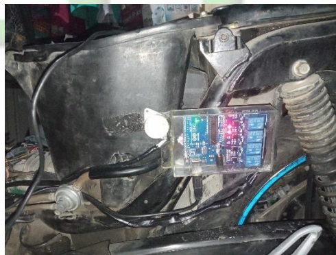
Gambar 3.6 Peletakan Modul Arduino Uno
