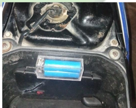
Gambar 4.18 Pemasangan Power Darurat
