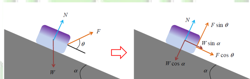
Sumber: Fisika-Dasar-1-Itb-Mikrajuddin-Abdullah-2016-Pdf. Gambar 2.9 (Kiri) Diagram Gaya Yang Bekerja Pada Benda, (Kanan) Diagram Gaya Yang Ekuivalen Dengan Gambar Kiri, Di Mana Berat Dan Gaya F Sudah Diganti Dengan Komponen-Komponen Yang Tegak Lurus.
