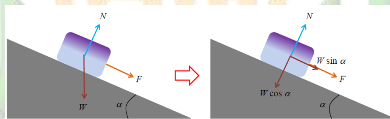
Sumber: Fisika-Dasar-1-Itb-Mikrajuddin-Abdullah-2016-Pdf. Gambar 2.7 (Kiri) Diagram Gaya Yang Bekerja Pada Benda, (Kanan) Diagram Gaya Yang Ekuivalen Dengan Gambar Kiri, Dimana Berat Sudah Diganti Dengan Dua Komponen Yang Tegak Lurus.
