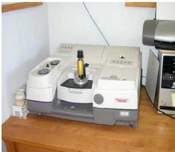
**Gambar 4.9 Alat Spektrum Inframerah**
