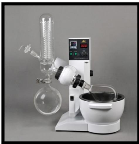
**Gambar 3.2 Alat Uap Evaporator**
