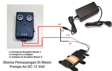
Gambar. 4 Rangkain pemasangan alat penyemprot otomatis
