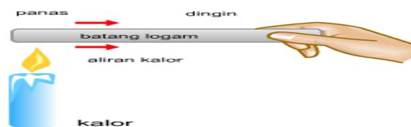
Gambar 2.8 Kalor Berpindah dari Suhu Tinggi ke Suhu Rendah
