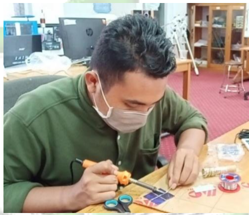
Gambar 4. 9 Penggabungan Sel Surya Menjadi Modul Surya
