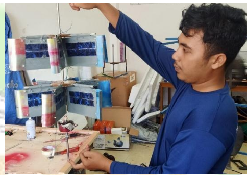
Gambar 4. 15 Lengan Bilah, Rotor Dan Bilah Baling-Baling Sel Surya.
