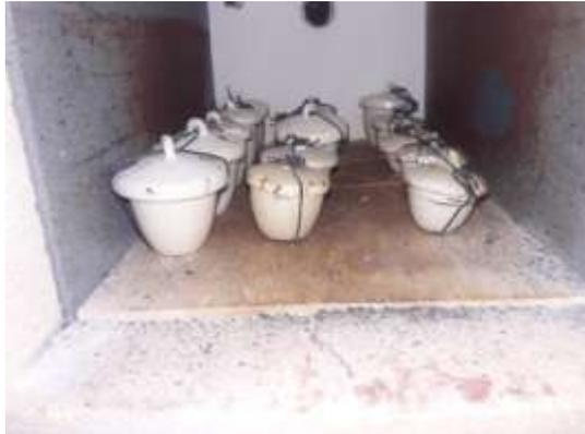
**Gambar 4.12. Pengujian Kadar Zat Mudah Menguap**
