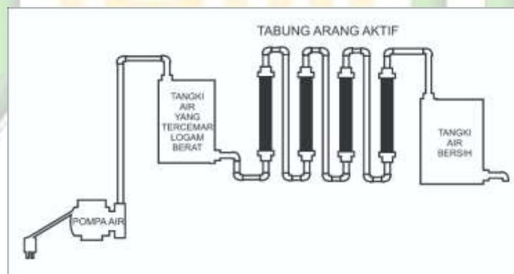
**Gambar 3.2. Rancang Bangun Alat Penjernih Air yang Tercemar Logam Berat Fe dengan Media Arang Aktif dari Limbah Tempurung Kelapa Sawit dan bambu (Pengembangan Setyobudiarso, 2014)**
