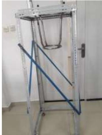
**Gambar 4.4. Penyangga Alat Penjernih Air**
