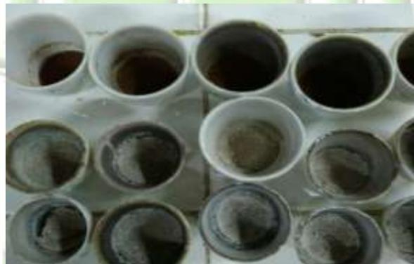
**Gambar 4.13. Sampel Arang Aktif Setelah Pengujian Kadar Abu**
