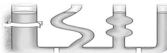
*Gambar 2.3 PermukaanZat Cair Dalam Bejana Berhubungan Dalam Bentuk Tabung Yang Berbeda Tetap Mendatar Dan Sama Tinggi.*
