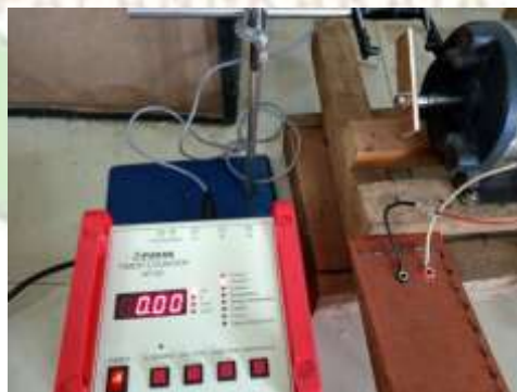
Gambar 4.2 Pengukuran Kecepatan Putar Generator (RPM)
