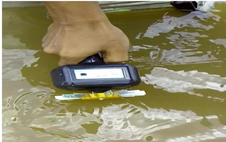
Gambar 4.7 Pengukuran Kecepatan Arus Air di Pintu Pesat Semi Bendungan Terapung
