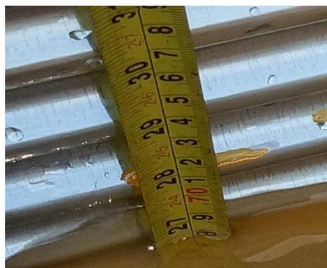
Gambar 4.6 Pengukuran Kedalaman Pintu Pesat Semi Bendungan Terapung
