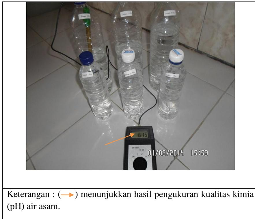
**Gambar 4.4 Pengukuran Kualitas Kimia (pH) Air Dengan Menggunakan pH Meter**
