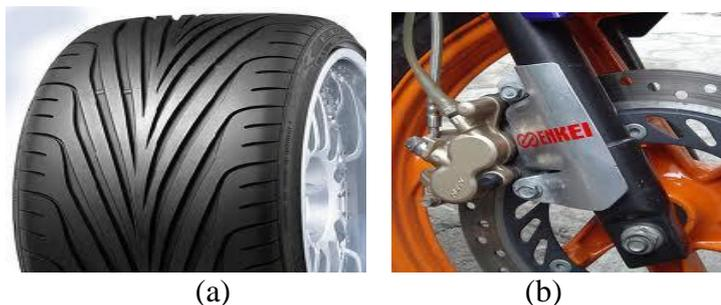
Gambar 2.8 (a) Ban mobil dibuat bergerigi agar gaya gesekan jalan dan ban cukup besar, (b) piringan rem sepeda motor yang menggunakan prinsip gesekan untuk pengereman.
